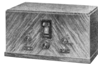
3-Röhren für Batteriebetrieb, (Schirmgitterhoch, Audion, NF) von Lange.
